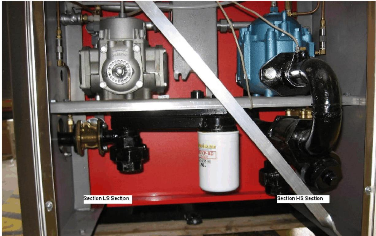
**Fig. 4: HS/LS-2-DYE inlet piping / Tuyauterie d'entrée du HS/LS-2-DYE**
