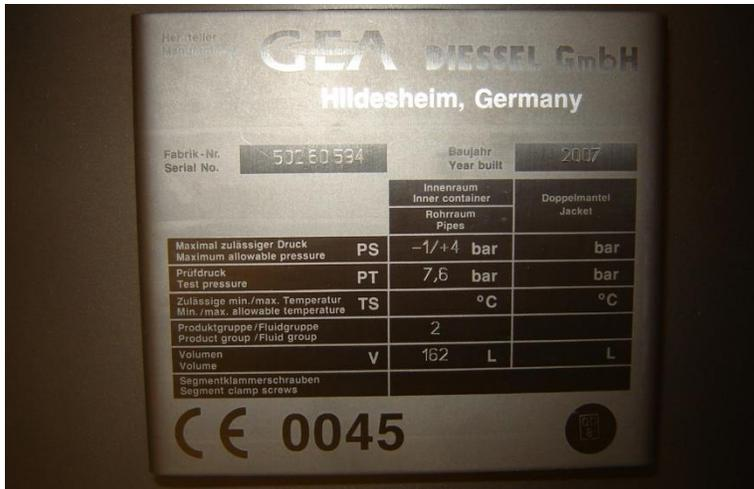
Figure 6: Typical Diessel GmbH nameplate | Plaque signalétique métallique typique du Diessel GmbH
