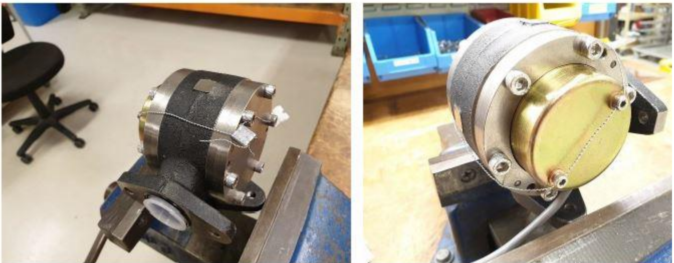
Figure 5 : Sealing of the meter and of the pulse outlet | Scellage du compteur et de la sortie d'impulsion
