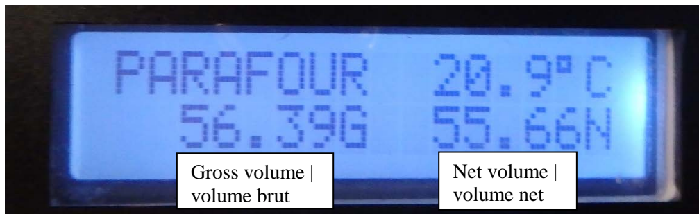
Figure 6: Gross and Net volume on the keypad display in test mode | Volume brut et net sur l'afficheur du clavier en mode test
