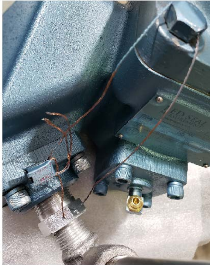
Figure 4: Sealing the ATC probe conduit with the meter | Le scellage du conduit de la sonde CAT avec le compteur
