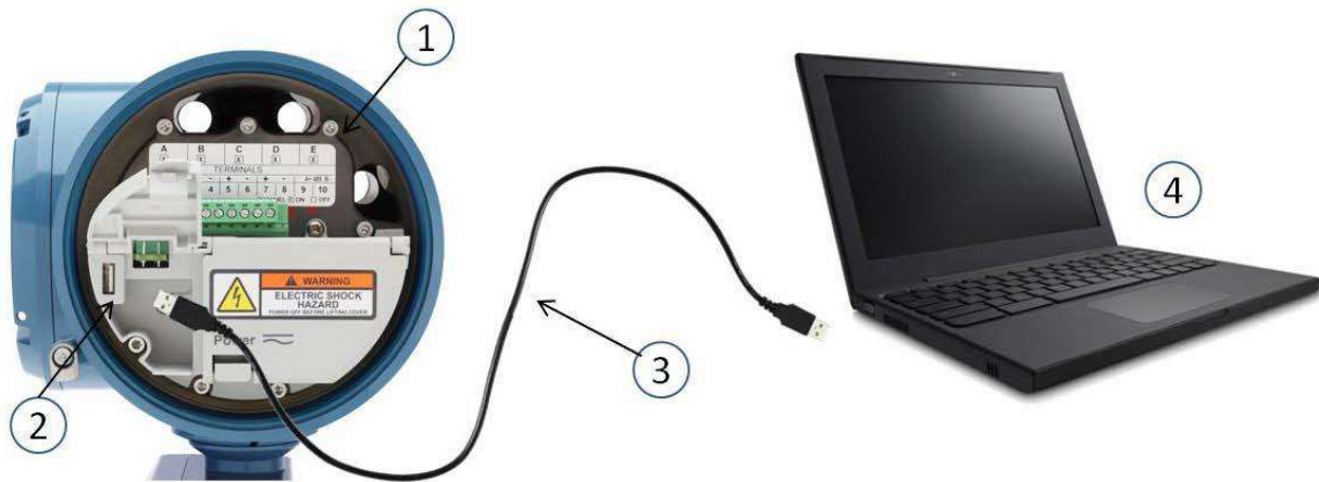
Figure 10: Accessing 5700 Transmitter parameters using ProLink: | Accès aux paramètres de transmetteur 5700 en utilisant le logiciel ProLink :
