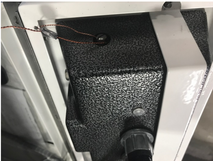
Figure 1 : MCR-09 register sealing / Scellage de l'enregistreur MCR-09
