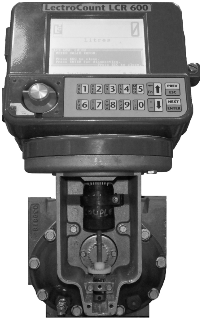
Figure 3 Meter with electronic register and special coupler | Compteur avec enregistreur électronique et coupleur spécial.
