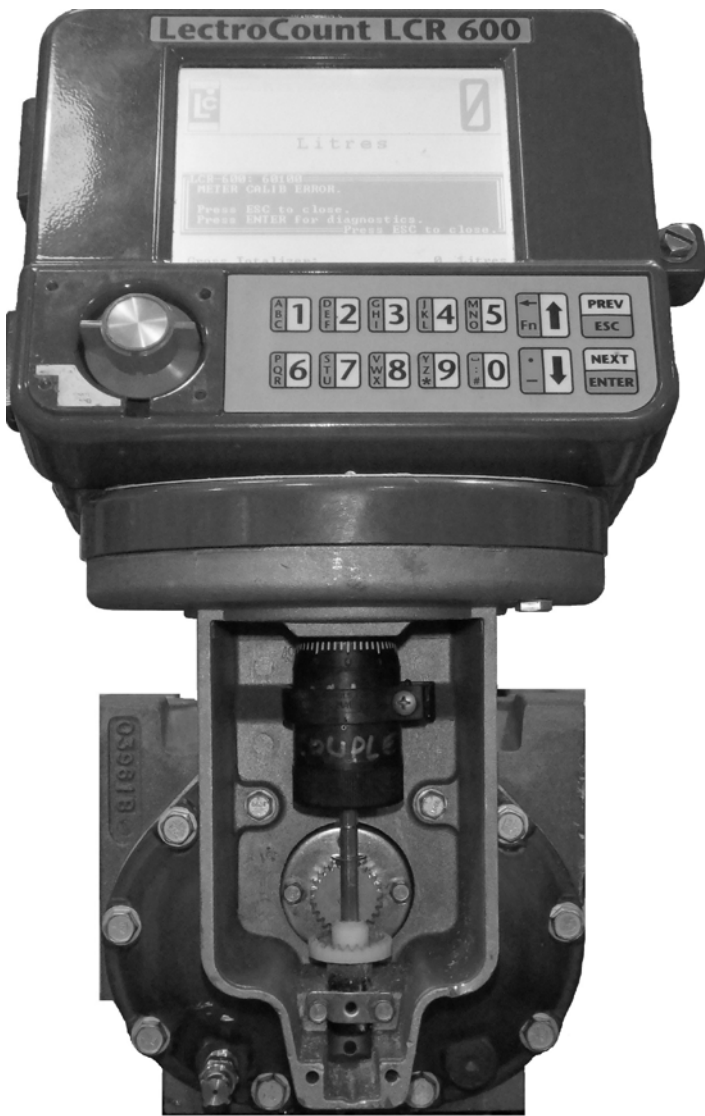
Fig 2: Meter with Electronic register and special coupler/ Compteur avec enregistreur électronique et accoupleur spécial
