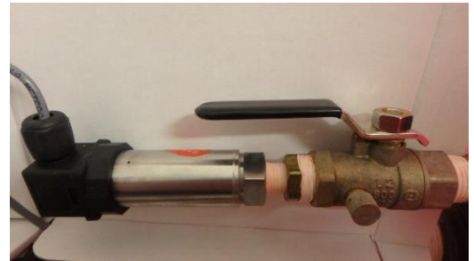
Figure 4 : Level sensor and simulation valve | Sonde de niveau et soupape de simulation
