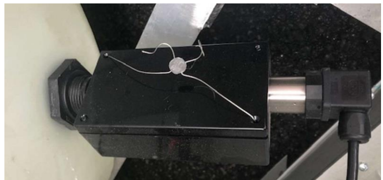
Figure 5 : Simulation valve sealing options | Options pour de scellage de la soupape de simulation
