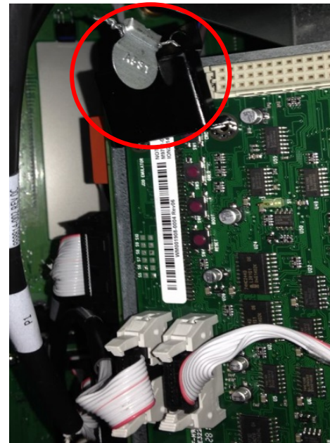
Figure 14: W&M Switch Cover and Seal / Le sceau et le couvercle de l'interrupteur de P et M
