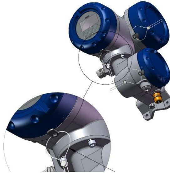
Figure 3: Sealing of the three caps on the MFC 400 (same for MFC 300 caps) | Scellage des trois couvercles du MFC 400 (le même pour les couvercles du MFC 300)
