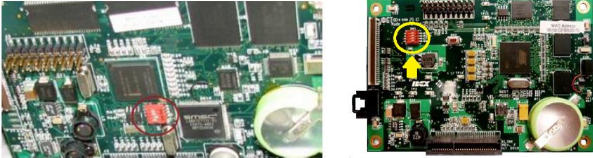
Figure 13: DIP switches for Program / Weights & Measures access; rev. 1.0 on old CPU board (left) and rev 2.1 on new CPU board (right) | Commutateurs DIP pour l'accès au programme / aux poids et mesures ; rév. 1.0 sur l'ancienne carte de CPU (gauche) et rév. 2.1 sur la nouvelle carte CPU (droite)
