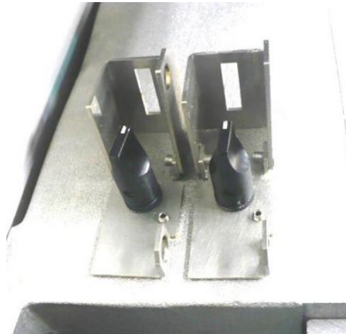
Figure 9: Key Switches (Type 1, one switch for Program Mode access, other for W&M change access ) | Interrupteur à clé (Type 1, un commutateur pour l'accès au mode programme, l'autre pour l'accès aux changements W&M)
