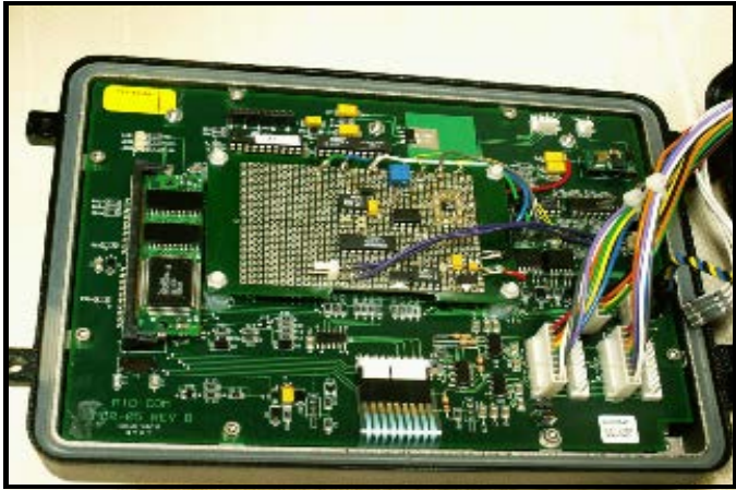
Fig. 4: E:Count MCR-05 circuit board with new temperature probe electronic components / Carte de circuits imprimés du E:Count avec composants électroniques pour la nouvelle sonde thermométrique
