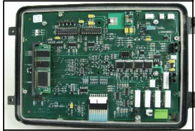
Fig. 5: E:Count MCR-05 circuit board with piggyback circuit incorporated into the main board/ Carte de circuits imprimés du E:Count avec carte ferrouitière incorporé dans la carte primaire.
