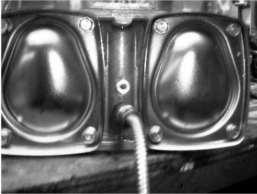
Fig. 2: Side view of iMETER with ATC probe and thermowell / Vue latérale du iMETER avec sonde et puits thermométrique du CAT
