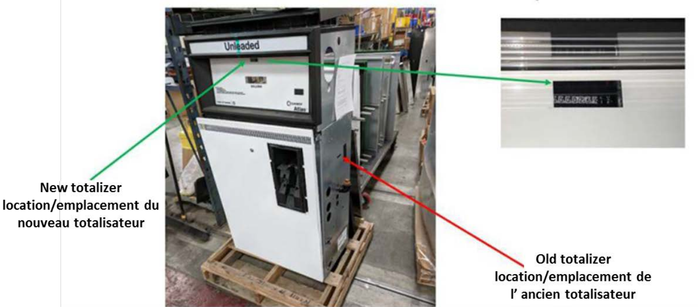
Figure 2. Location of the old and new totalizers | Emplacement des anciens et nouveaux totalisateurs
