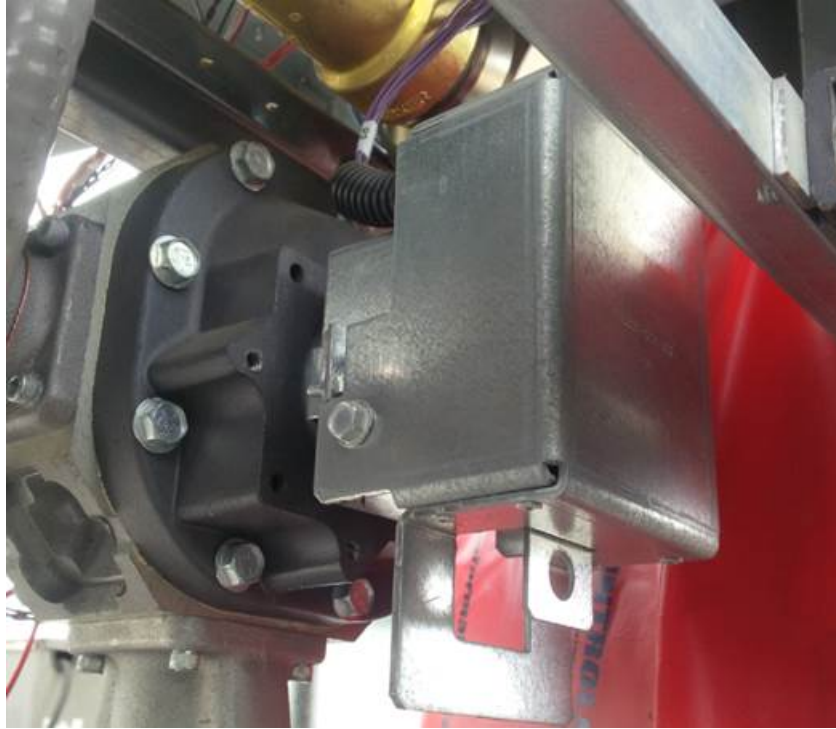
Fig. 4 Optional factory installed security cover for M5 equipped models for owner supplied lock. Sealing under the cover is the same as shown in Hydraulic structure of High Speed dispensers | Couvercle facultatif de sécurité installé en usine pour les modèles équipés du M5 pour serrure fourni par le propriétaire. La scelle sous le couvercle est la même que celle indiqué dans l'installation hydraulique des distributeurs à capacité élevée.
