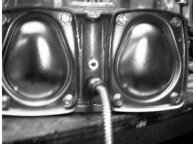
Fig. 2: Side view of iMETER with ATC probe and thermal well | Vue latérale du iMETER avec la sonde de la CAT et le puits thermométrique
