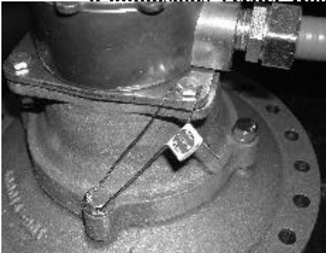
Pulser housing to meter seal/ Sceau reliant le boîtier du générateur d'impulsions au compteur
