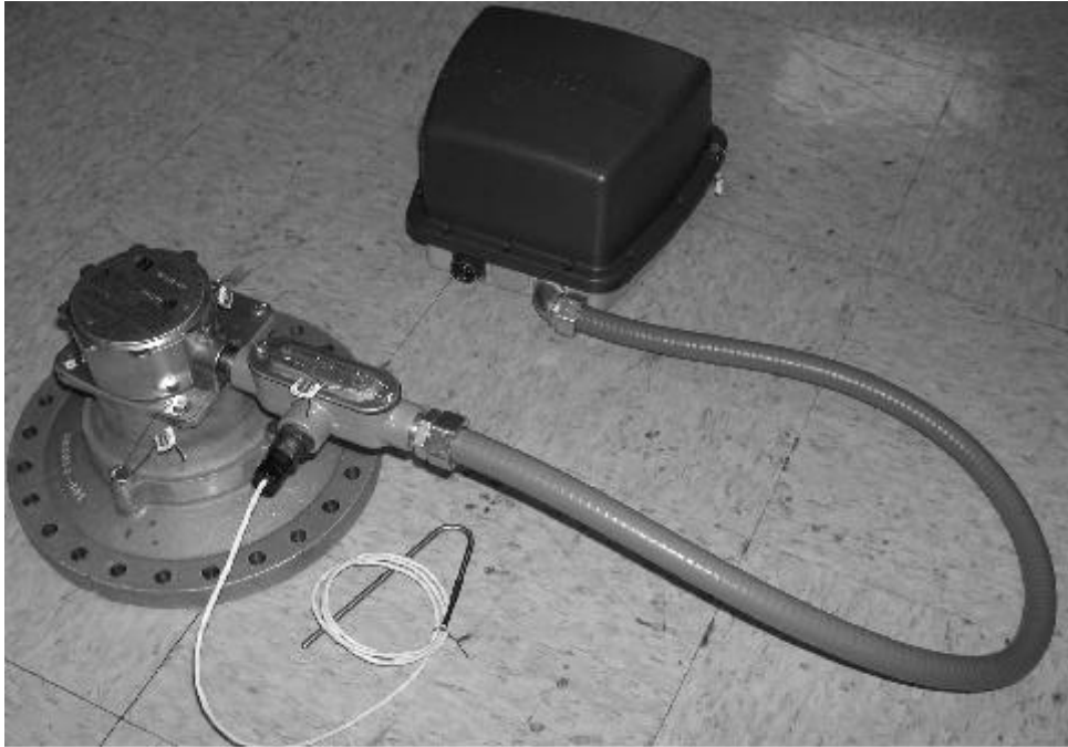
Veeder-Root pulser with remote E4000 register/Générateur d'impulsions Veeder-Root avec enregistreur E4000 installé à distance
