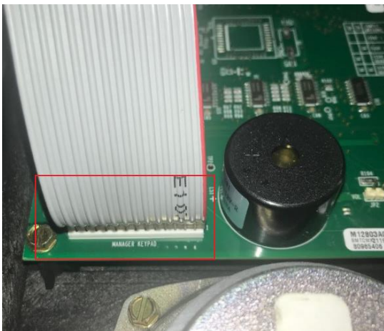
Figure 12: Manager Keypad plugin location, differs by model | Endroit pour rebrancher le clavier du gestionnaire varie selon le modèle
