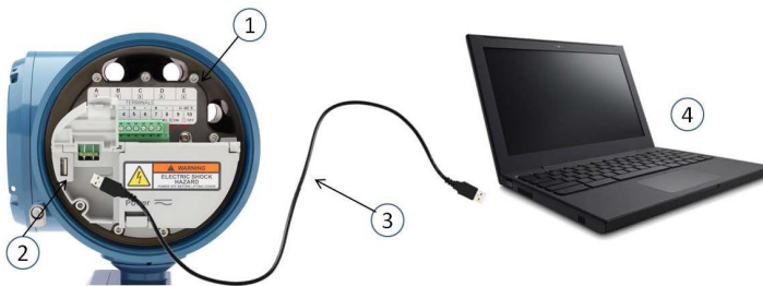
Figure 12 Accessing 5700 parameters using ProLink: | Accès aux paramètres de 5700 en utilisant le logiciel ProLink :
