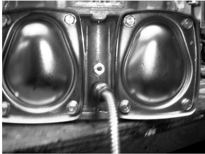
Fig. 3: Side view of iMETER with ATC probe and thermowell / Vue latérale du iMETER avec sonde du CAT et le puits thermométrique
