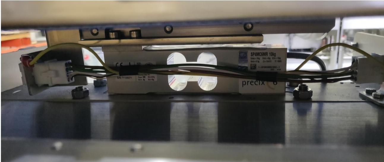
Typical load cell and sub-platter / Cellule de pesage et sous-plateau typique
