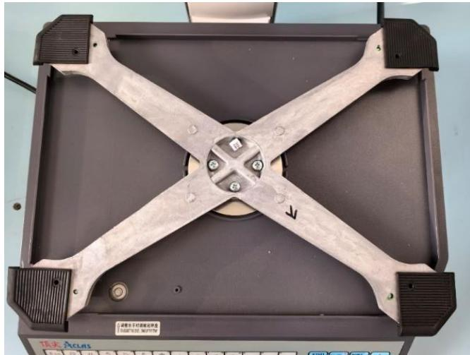
Typical iS2X/iS3X Sub-platter / Sous-plateau typique iS2X/iS3X
