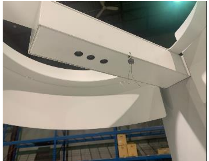
Typical camera and sealing (POS and POS Lite kiosk) / Caméra et scellage typiques (POS et POS Lite kiosque)
