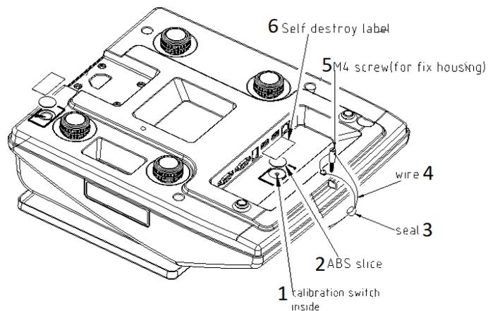
1. Interrupteur d'étalonnage à l'intérieur
