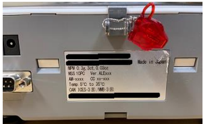
Typical sealing for enclosure of models MG-S1501 and MG-S8200 / Scellage typique de le retrait du couvercle pour les modèles MG-S1501 et MG-S8200
