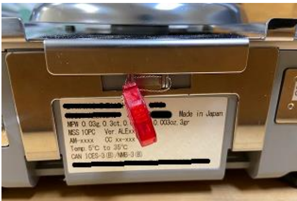
Typical sealing for enclosure of model MG-S322 / Scellage typique de le retrait du couvercle pour le modèle MG-S322
