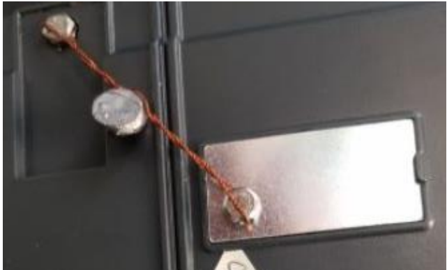
Typical sealing found under device / Le scellage typique qui se trouve sous l'appareil
