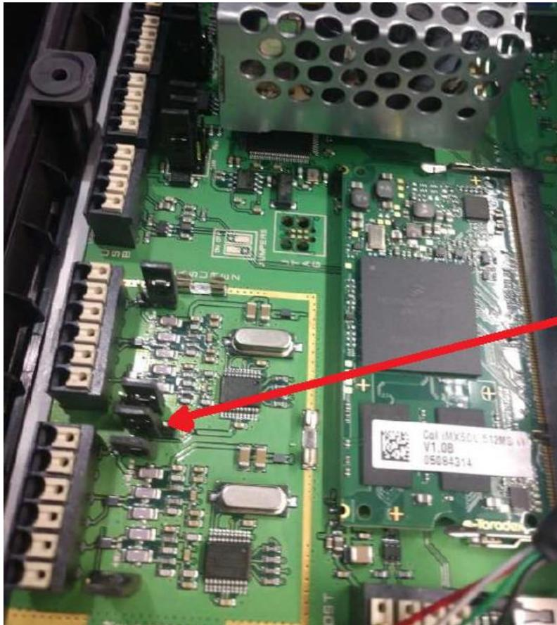
Jumper in locked/sealed position (see above) / Le cavalier est en position verrouillée (voir ci-dessus)
