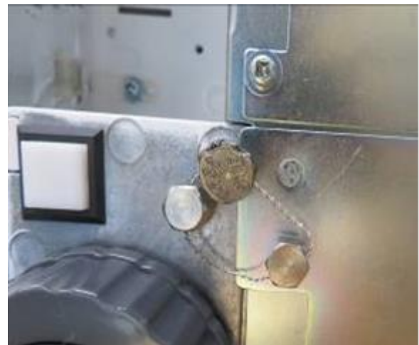
Typical Sealing for RM-5900x on the calibration switch bracket / Scellage typique pour le RM-5900x sur le support du commutateur d'étalonnage
