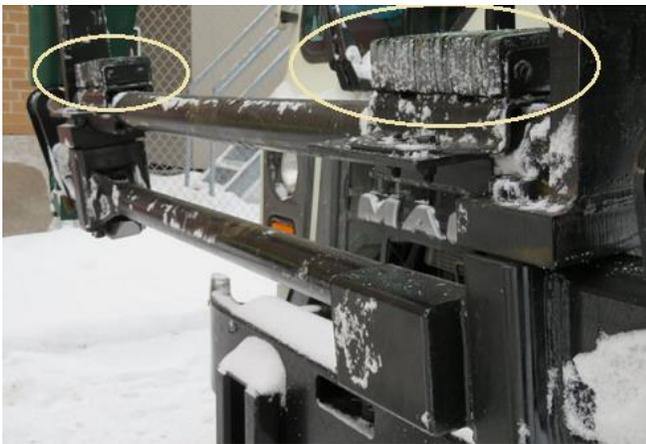
**Typical load cell mounting / Montage typique d'une cellule de charge**
