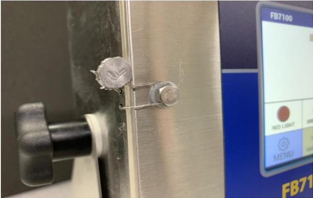
**Typical Sealing of Model FB71x2 / Scellage typique du modèle FB71x2**
