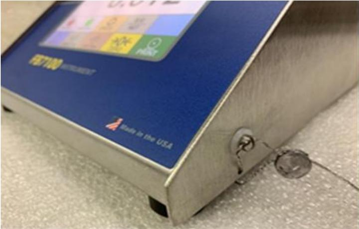
**Typical Sealing of Model FB71x1 / Scellage typique du modèle FB71x1**
