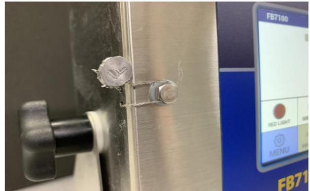
**Typical Sealing of Model FB71x2/ Scellage typique du modèle FB71x2**
