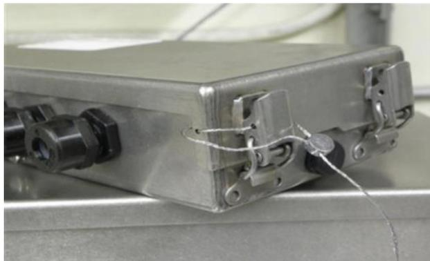
**Sealing of sectional controller model ACC-2000-XX/ Scellage du contrôleur de section modèle ACC-2000-XX**
