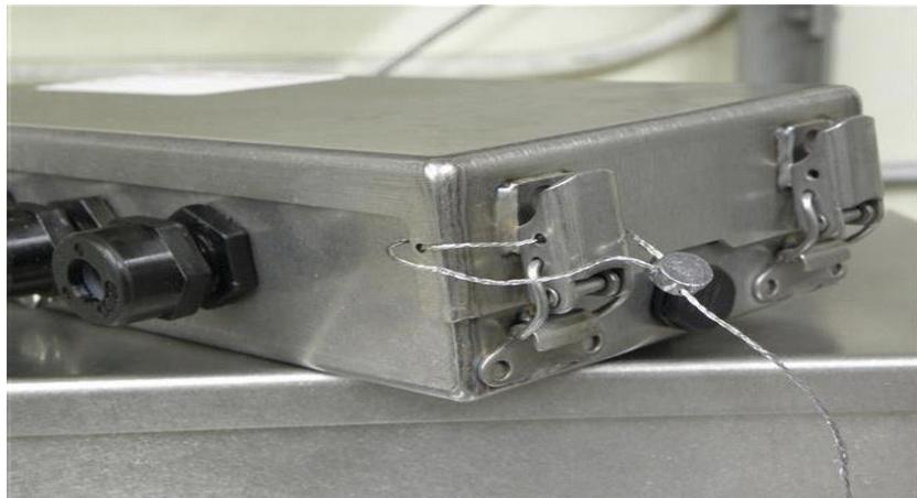
**Sealing of sectional controller model ACC-2000-XX/ Scellage du contrôleur de section modèle ACC-2000-XX**
