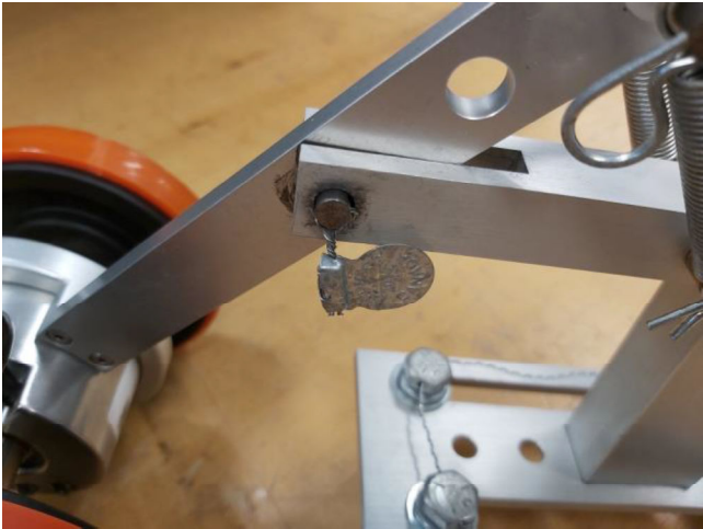
Figure 5 Typical tachometer sealing / Scellage typique du tachymètre
