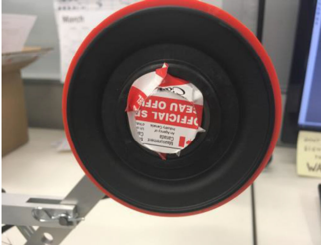
Figure 5 Typical tachometer sealing / Scellage typique du tachymètre
