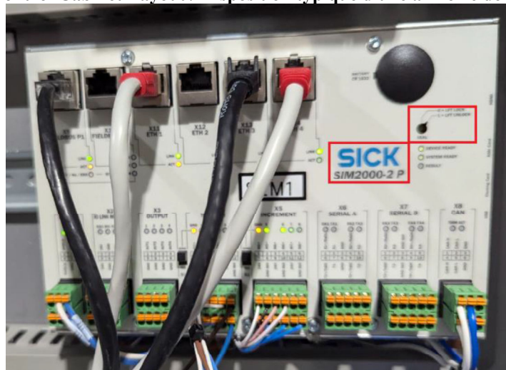
SIM2000-2 P System Controller (Seal must be set to 0 = LFT Lock) / Contrôleur système SIM2000-2 P (le sceau doit être réglé sur 0 = verrouillage LFT)
