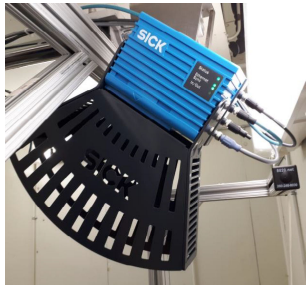
Typical dimensioning sensor head / Capteur de dimension typique
