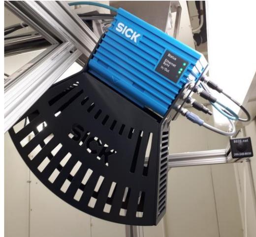
**Typical dimensioning sensor head / Capteur de
