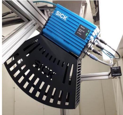
**Typical dimensioning sensor head / Capteur de
