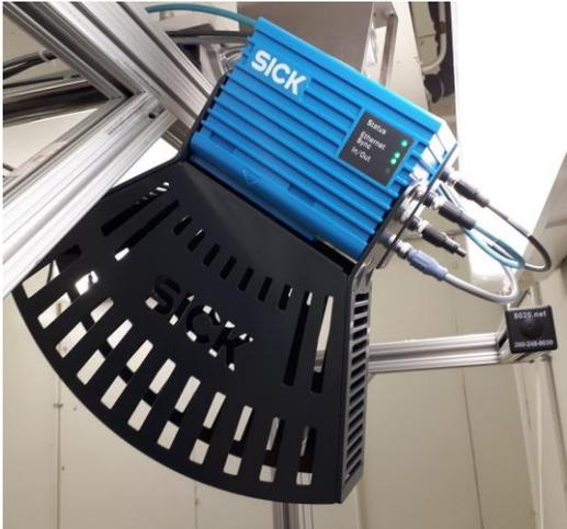
**Typical dimensioning sensor head / Capteur de
