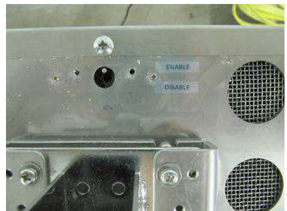
Typical calibration switch access for SM-5300H / Mode d'accès à l'interrupteur d'étalonnage typique pour SM-5300H
