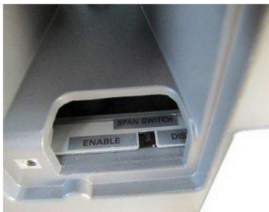
Typical calibration switch access for SM-5300SSP / Mode d'accès à l'interrupteur d'étalonnage typique pour SM-5300SSP
