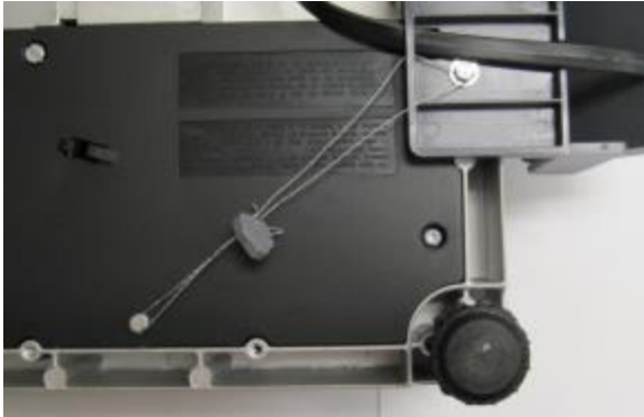
Alternative sealing method below scale / Méthode alternatif de scellage sous la balance
