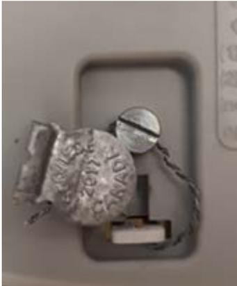
**Typical PRyNz sealing on bottom of device/ Scellage PRyNz typique au bas de l'appareil**
