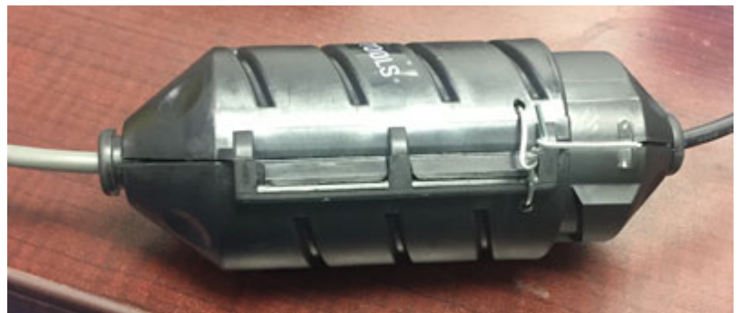
Example of sealing on bar code reader / Exemple du scellage sur le lecteur de code-barres
