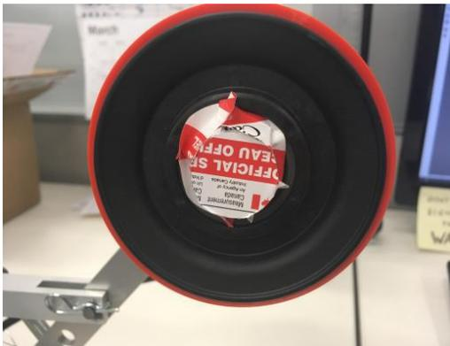
**Typical tachometer sealing / Scellage typique du tachymètre**
