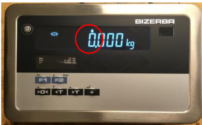
Typical Model, with calibration switch status annunciator circled / Modèle typique, avec le voyant d'état du commutateur d'étalonnage encerclé
