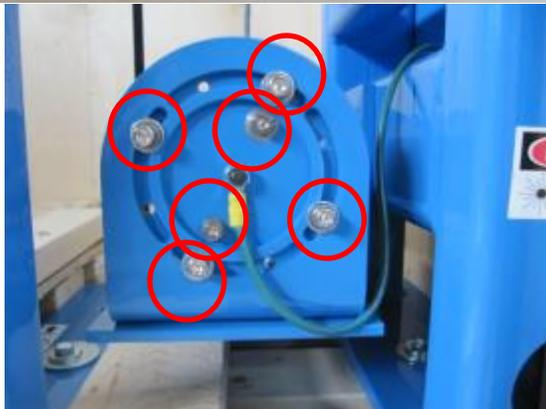
**Typical sensor head sealing (circled screws) / Scellage typique des capteurs (vis encerclées)**
