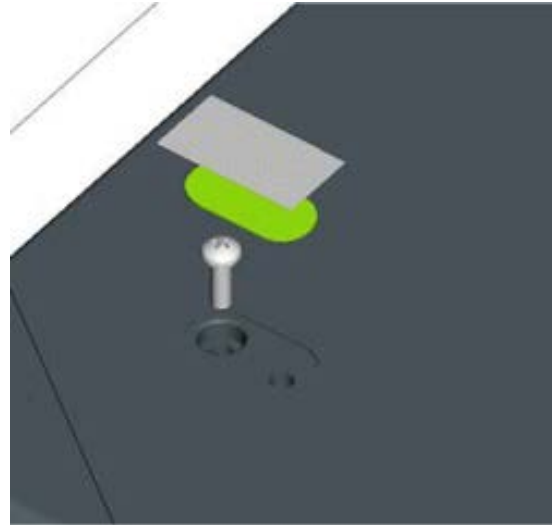
Typical sealing (use official Measurement Canada seals only) / Scellage typique (utilisez seulement les scellés officiels du Mesures Canada)
