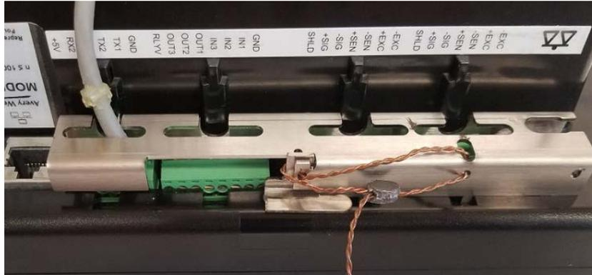
**Typical ZK840-PD5 Sealing to the ZB210-# junction box / Scellage ZK840-PD5 typique à la boîte de jonction ZB210-#**
