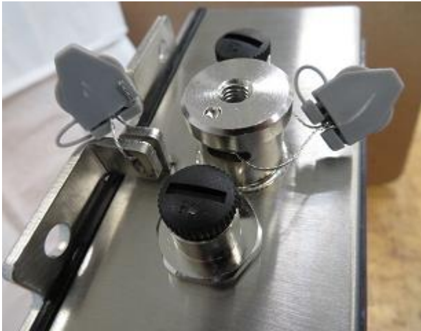
Typical sealing of the indicator and calibration switch for model TLF820 / Scellage typique de l'indicateur et du commutateur d'étalonnage pour le modèle TLF820
