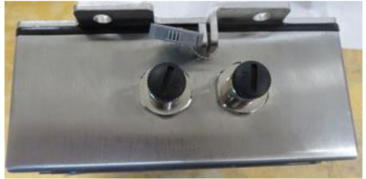
Typical sealing of the indicator and calibration switch for model TLF820 / Scellage typique de l'indicateur et du commutateur d'étalonnage pour le modèle TLF820
