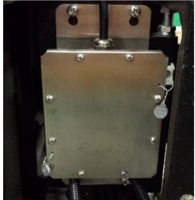
Typical sealing of the junction box for model VFS120 / Scellage typique de la boîte de jonction pour le modèle VFS120
