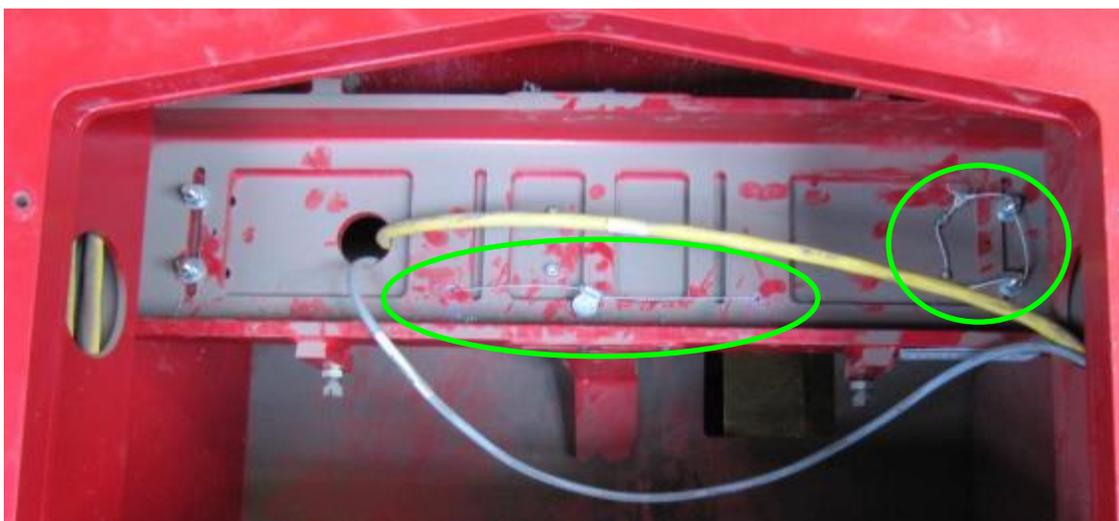
**Typical sensor head sealing (circled screws and holes) / Scellage typique des capteurs (vis et trous encerclés)**
