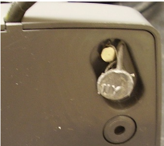
Typical Sealing of Indicator (Wire Seal) / Scellage typique du dispositif indicateur (scellé de fil)
