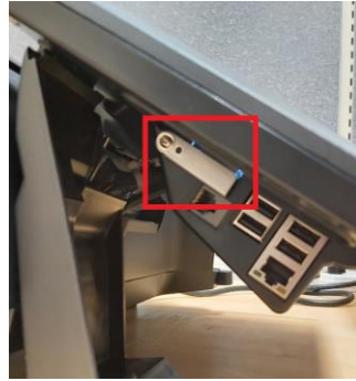
Typical SD card sealing under the operator's keyboard / Scellage typique de la carte SD sous le clavier de l'opérateur
