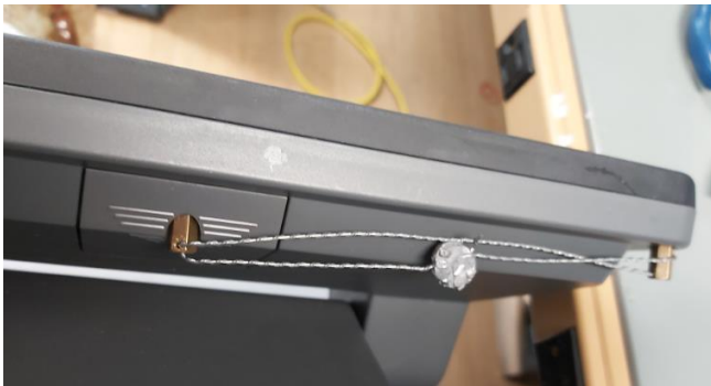
Typical SD card sealing for SM-5300EV / Scellage typique de la carte SD pour SM-5300EV
